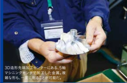
3D造形先端加工センターにある、5軸マシニングセンターで加工した金属。複雑な形も、一度に削ることが可能だ。
